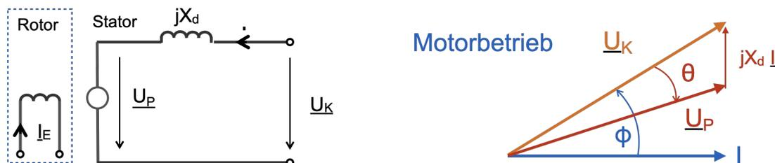
Hierbei bezeichnen  $I_E$  den Erregerstrom,  $\underline{U}_P$  die Polradspannung,  $\underline{I}$  den Statorstrom und  $\underline{U}_K$  die Klemmenspannung am Stator. Aus dem Ersatzschaltbild ergibt sich die Gleichung  $\underline{U}_K = \underline{U}_P + jX_d \underline{I}$ .
