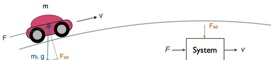
Abbildung 1.1 Modell des Fahrzeugs als bewegte Punktmasse
