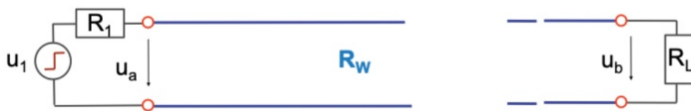
Abbildung 2.6.1 Endliche Leitung mit Abschlusswiderstand und Innenwiderstand der Quelle
